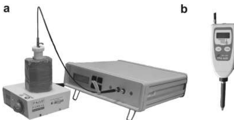
Obr. 1: Optické biosensory pro detekci halogenovaných kontaminantů založené na aktivitě halogenalkandehalogenas: a) první prototyp biosensory (25×7×25 cm), b) nově vyvinutý příruční biosensor EnviroPen (6×3×19 cm, www.enantis.com ).
