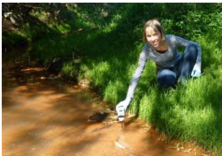
Obr. 3: Využití EnviroPenu pro stanovení halogenovaných derivátů uhlovodíků na kontaminované lokalitě (Neratovice, Česká republika).
