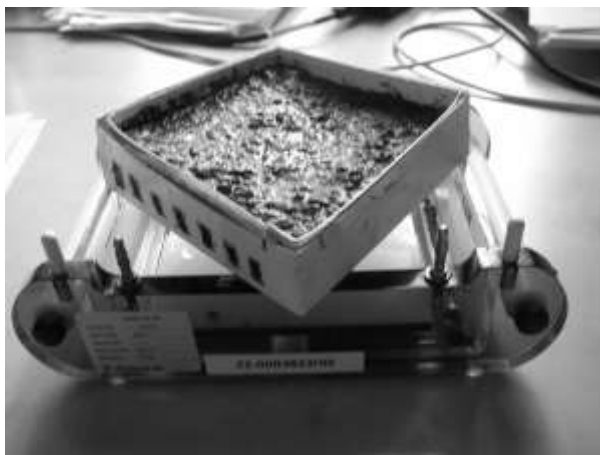
Obr. 2 Aparatura pro elektrokinetickou dekontaminaci – MIDI-1 Electrophoresis Unit bez nosiče gelu nahrazeného v laboratoři vyrobenou plastovou nádobkou na zeminu
