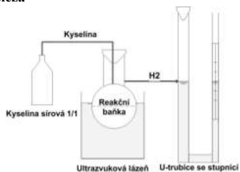
Obr. 1 Schéma aparatury ke stanovení Fe^0
